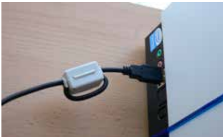
Klappkern auf dem USB-Kabel am Computer
